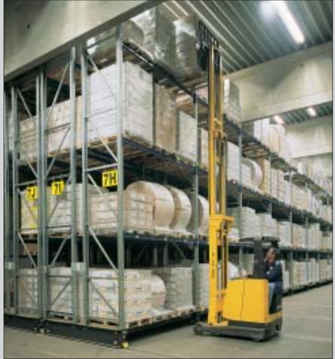
A mobil állványokhoz rendszerint tolóoszlopos targoncát használnak.
