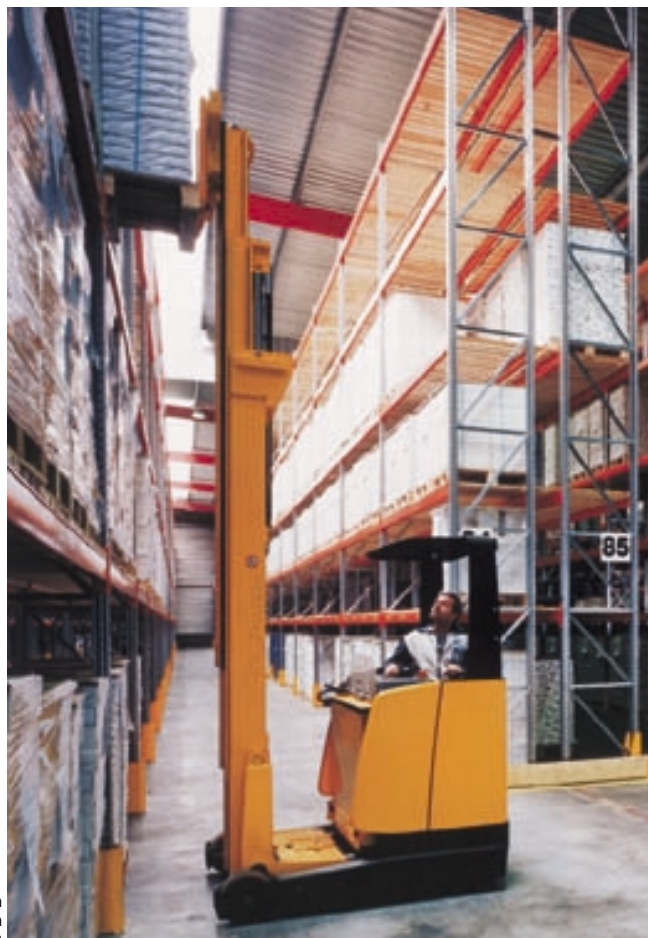
Tolóoszlopos targonca hosszanti áthidalós állványba történő betárolás közben
