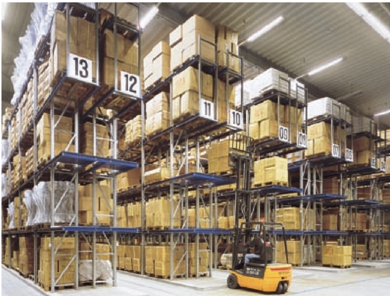
Egy logisztikai szolgáltató magasraktári állványrendszere
