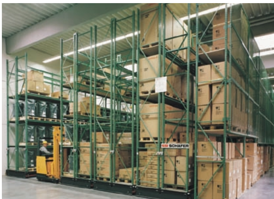
Mobil állványrendszer hosszanti áthidalókkal
