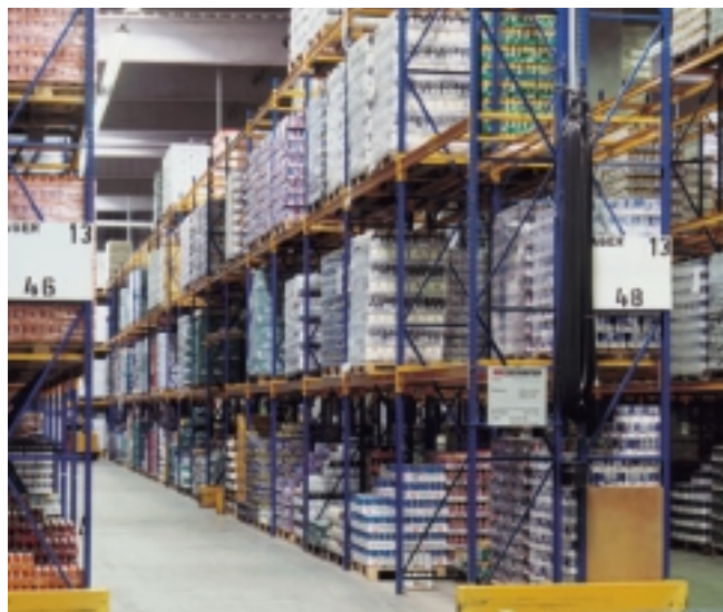
Hosszanti áthidalós állvány egy élelmiszerkereskedésben
