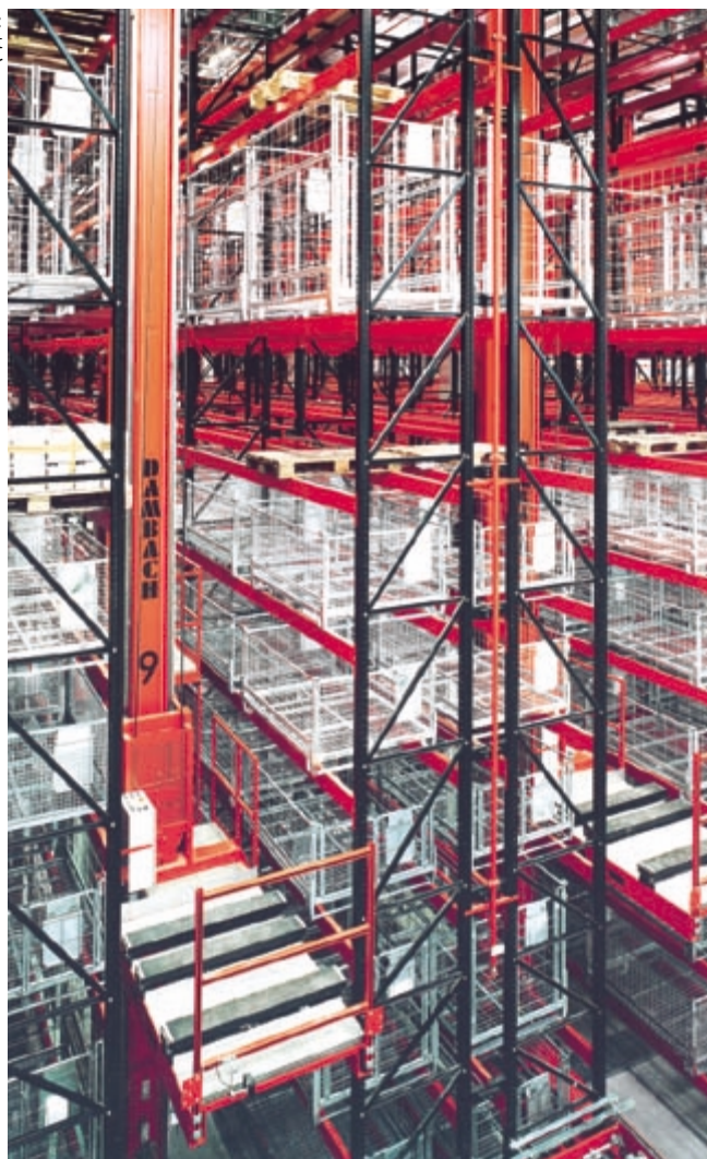
Felső és jobb alsó kép: magas állvánnyal beépített készáruraktár
