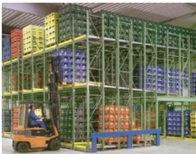
Raklapos, előlről tölthető (LIFO) állvány kommissiózó szintekkel
