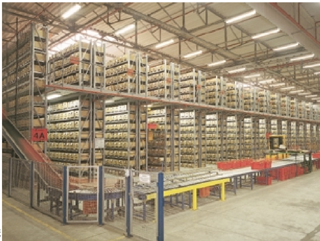
Állványgalériaként kialakított raklapos állvány egy kommissiózó raktárban
