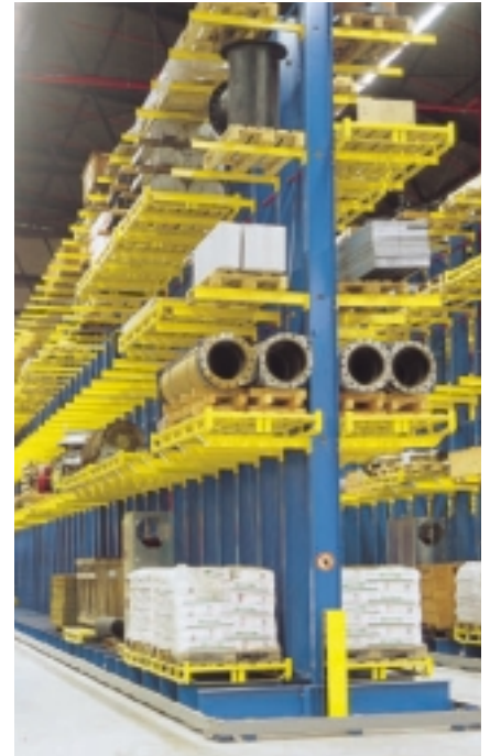
Karos állvány megvezetősínnel négyutas targoncához
